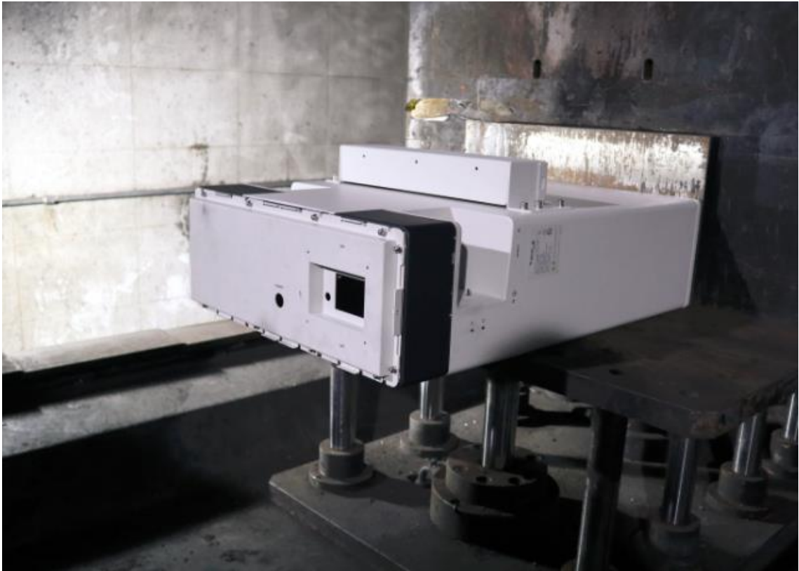
图7、E-20090038-002样品挤压测试前安装位置照片
