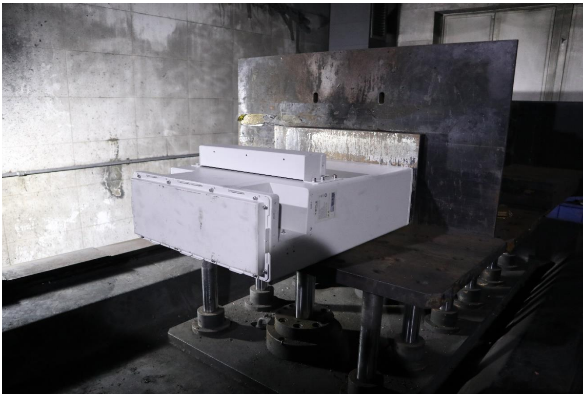
图2、E-20090038-001样品挤压测试前安装位置照片
