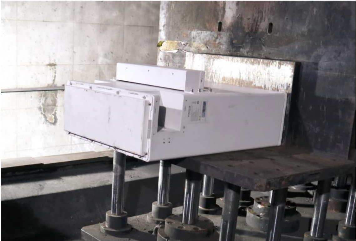
图3、E-20090038-001样品挤压测试后安装位置照片
